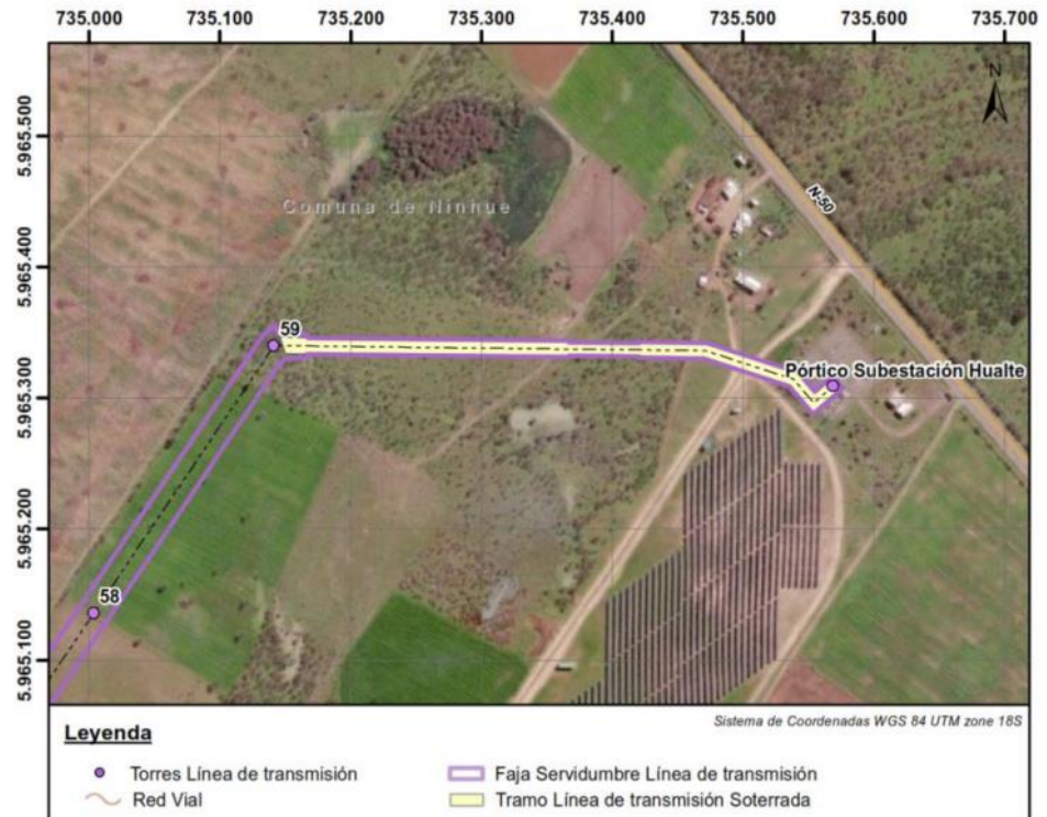
Figura: Acometida soterrada de la Línea de transmisión a la subestación Hualte.
