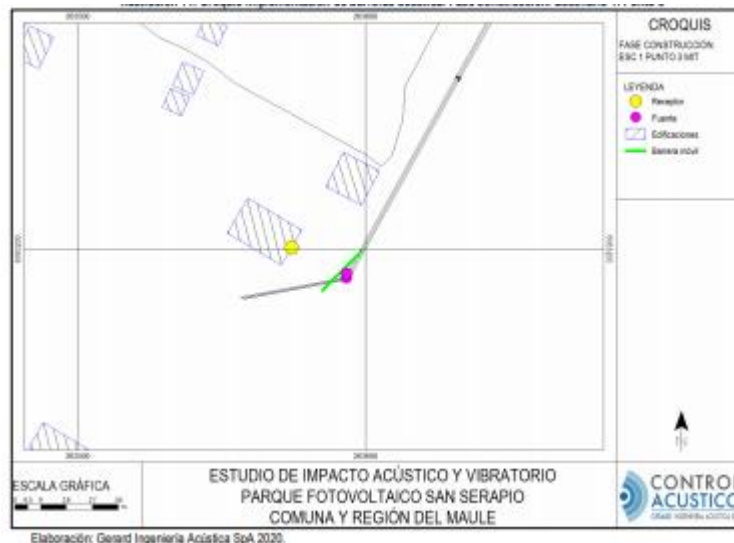
Figura N°9. Croquis implementación de barreras acústica. Fase construcción. Escenario 1. Punto 2.
