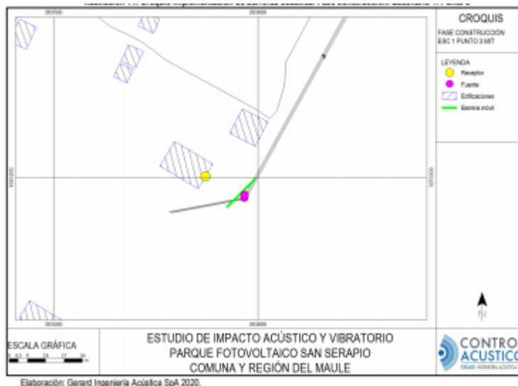
Figura N°5. Croquis implementación de barreras acústica. Fase construcción. Escenario 1. Punto 3.
