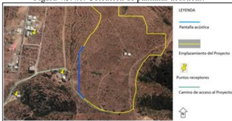
Figura 4.3.4.1: Ubicación de pantallas acústicas.
