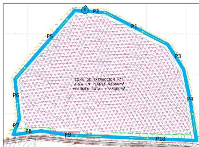
Figura 7. Zona de contrafoso en celeste, rodeando el área de la Cuña 1.
