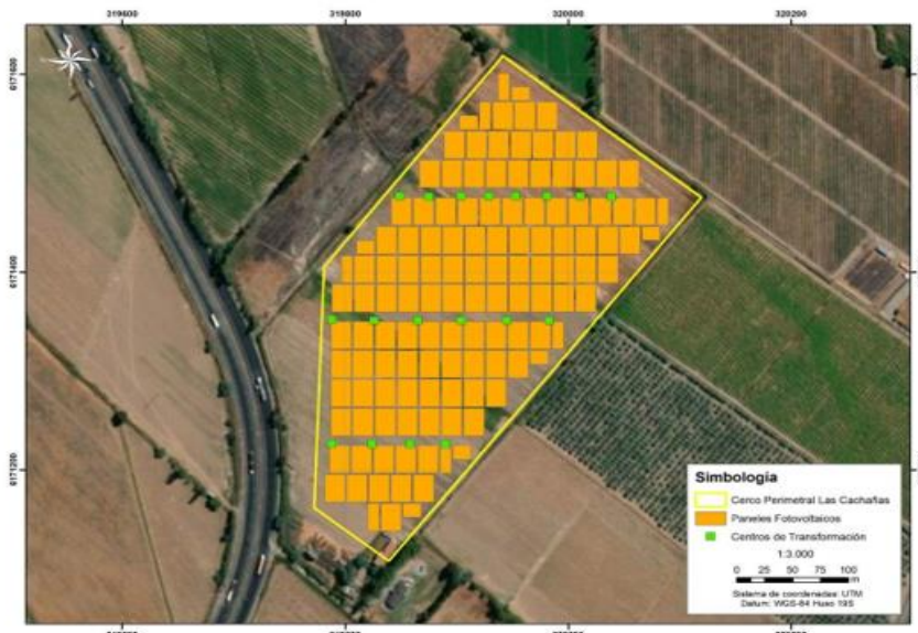
Figura 2.8-2 Ubicación Centros de Transformación Fuente: Elaboración propia
