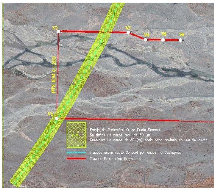
Trazado Franja de Proyección Cruce Ducto SONACOL.
